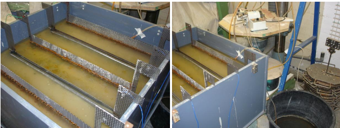
Bild 5 Vertikale Anordnung der Elektroden (links) und Absaugen des abgetrennten Wasser an der Oberfläche (rechts), Versuchsserie V3
