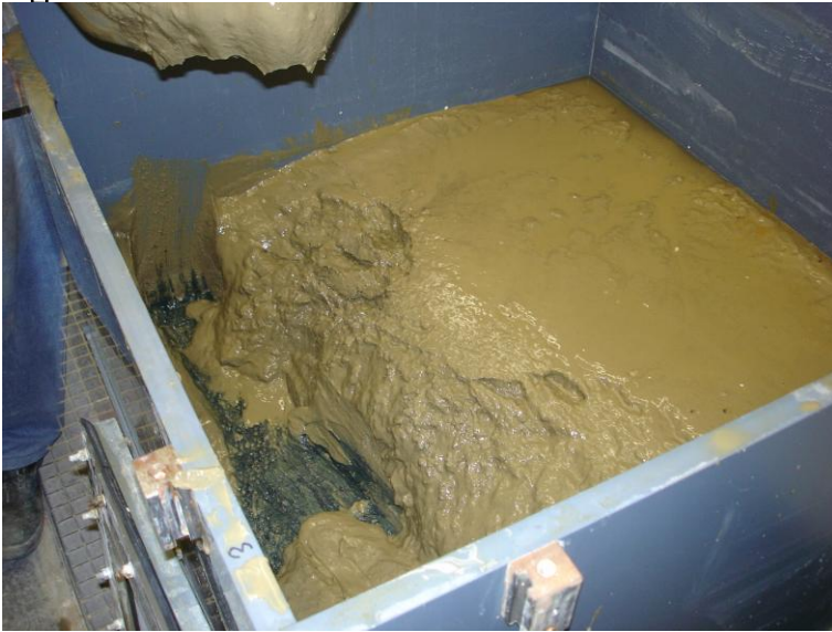
Bild 4 Stichfestes Bentonit nach der Elektroosmose bei der Versuchserie V2
