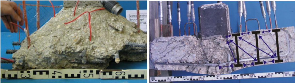
Bild 3 Durchstanzkegel bzw. Sägeschnitte von Versuchskörpern
